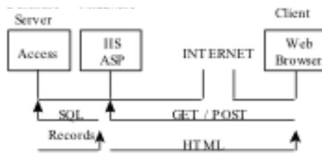
Il Client mediante il metodo Post o Get del protocollo HTTP fa delle richieste al Web Server.
